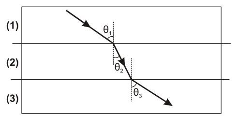
Για τις γωνίες του σχήματος δίνεται ότι θ<sub>3</sub> > θ<sub>1</sub> > θ<sub>2</sub>.
