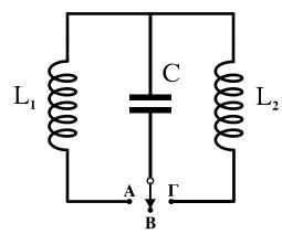
Τη χρονική στιγμή  $t_0$  = 0 ο διακόπτης τίθεται στη θέση A και αρχίζει να εκτελείται ηλεκτρική ταλάντωση με περίοδο T. Τη χρονική στιγμή  $t_1 = \frac{5T}{8}$  ο διακόπτης μεταφέρεται στη θέση  $\Gamma$ . Αν  $I_{max,1}$  είναι το μέγιστο ρεύμα στο κύκλωμα  $L_1C$  και  $I_{max,2}$  το μέγιστο ρεύμα στο κύκλωμα  $L_2C$ , τότε:
